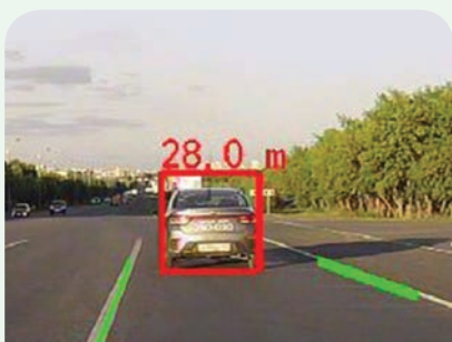
определение расстояния до транспортного средства, движущегося в попутном направлении
