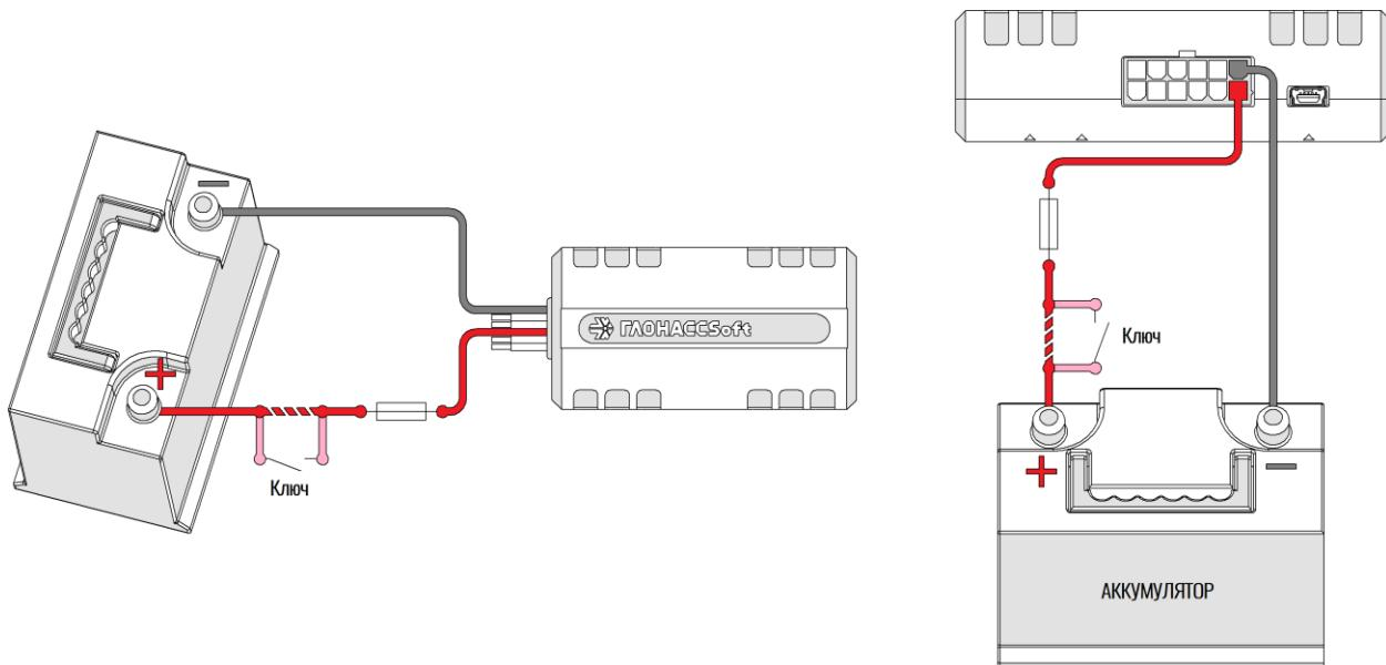
Рисунок 2.10 Подключение питания (310 – слева; 312 -справа)
