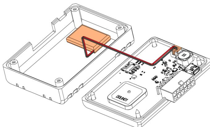
Рисунок 2.9 Установка аккумулятора
