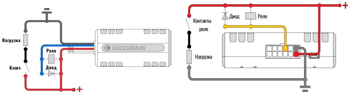
Рисунок 2.17 Подключение мощной нагрузки (310 – слева; 312 - справа)
