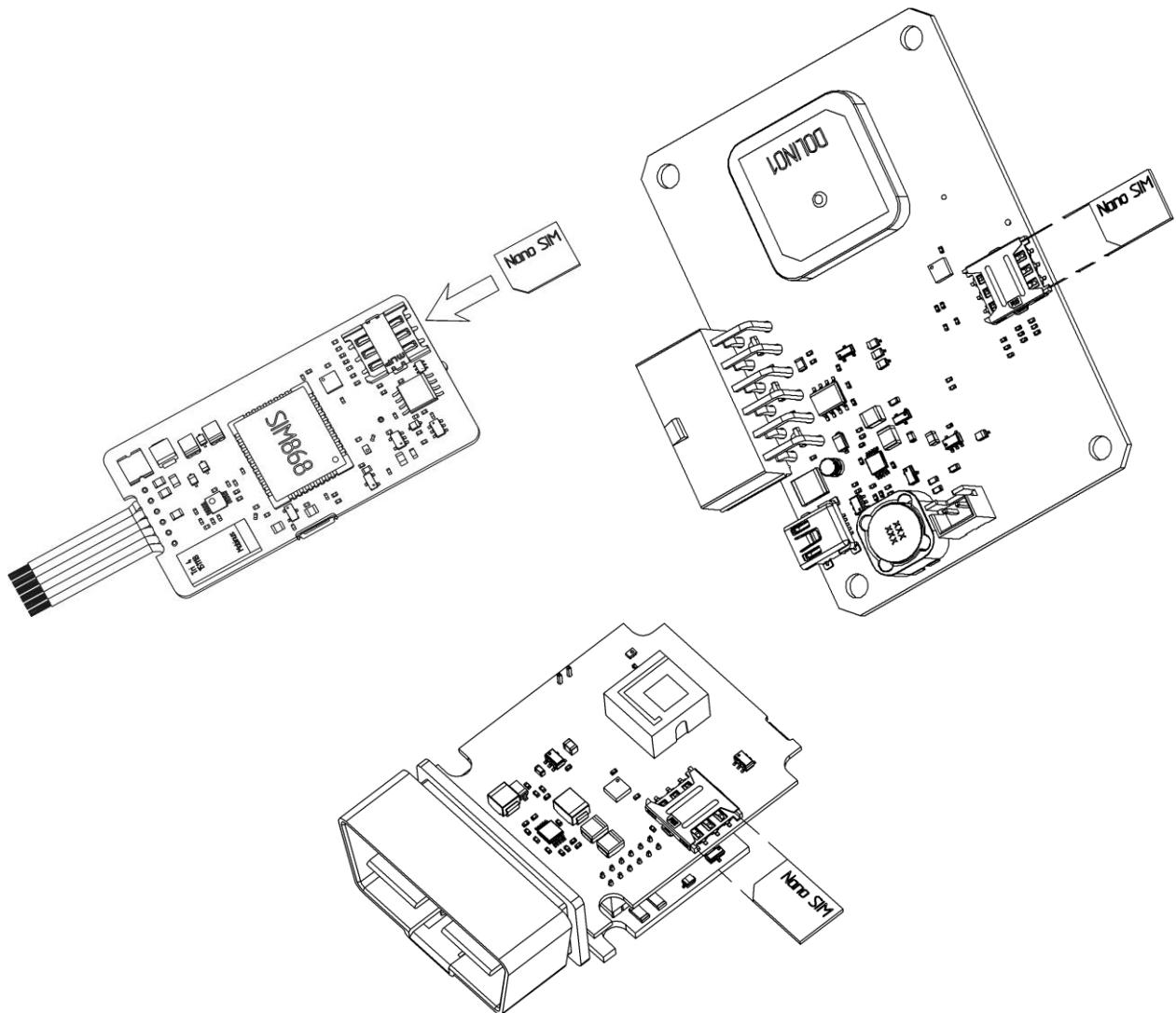
Рисунок 2.8 Установка SIM-карты (310 – слева; 312 – справа; 311 - снизу)
