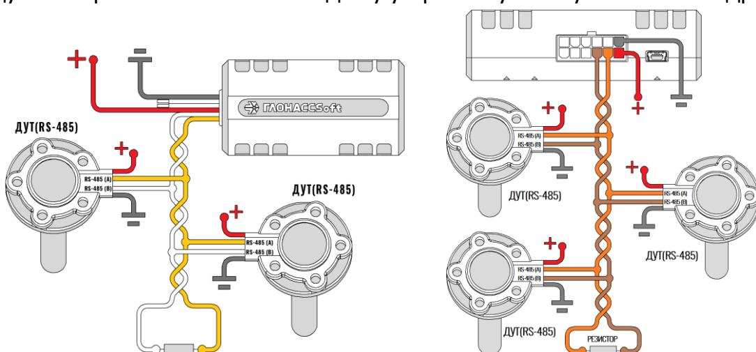
Рисунок 2.18 Подключение ДУТ по интерфейсу RS-485 (310 – слева; 312 - справа)
