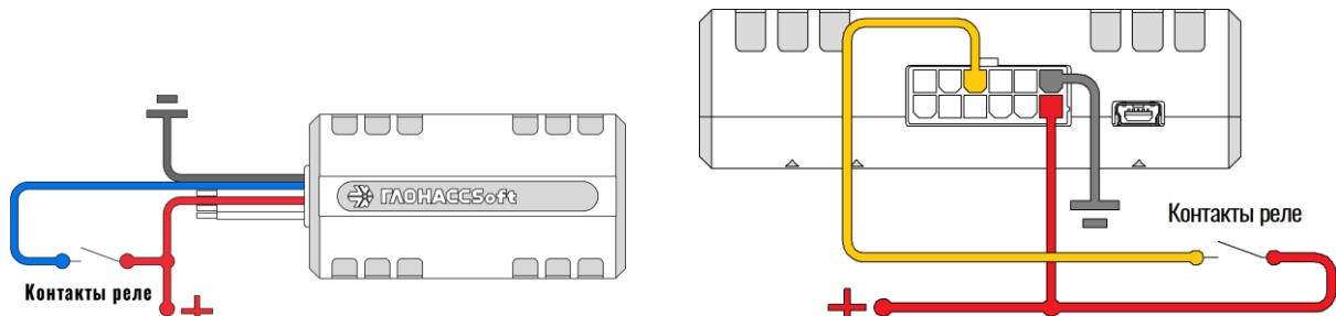
Рисунок 2.15 Варианты подключения дискретных датчиков
