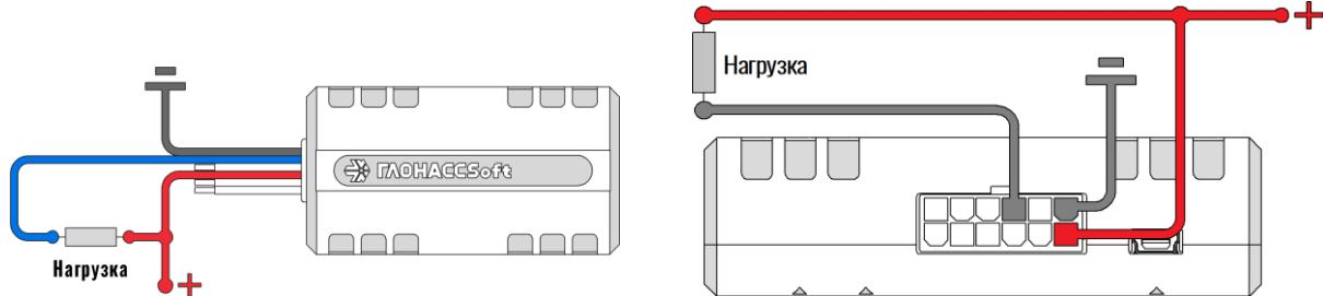
Рисунок 2.16 Подключение маломощной нагрузки (310 – слева; 312 – справа)
