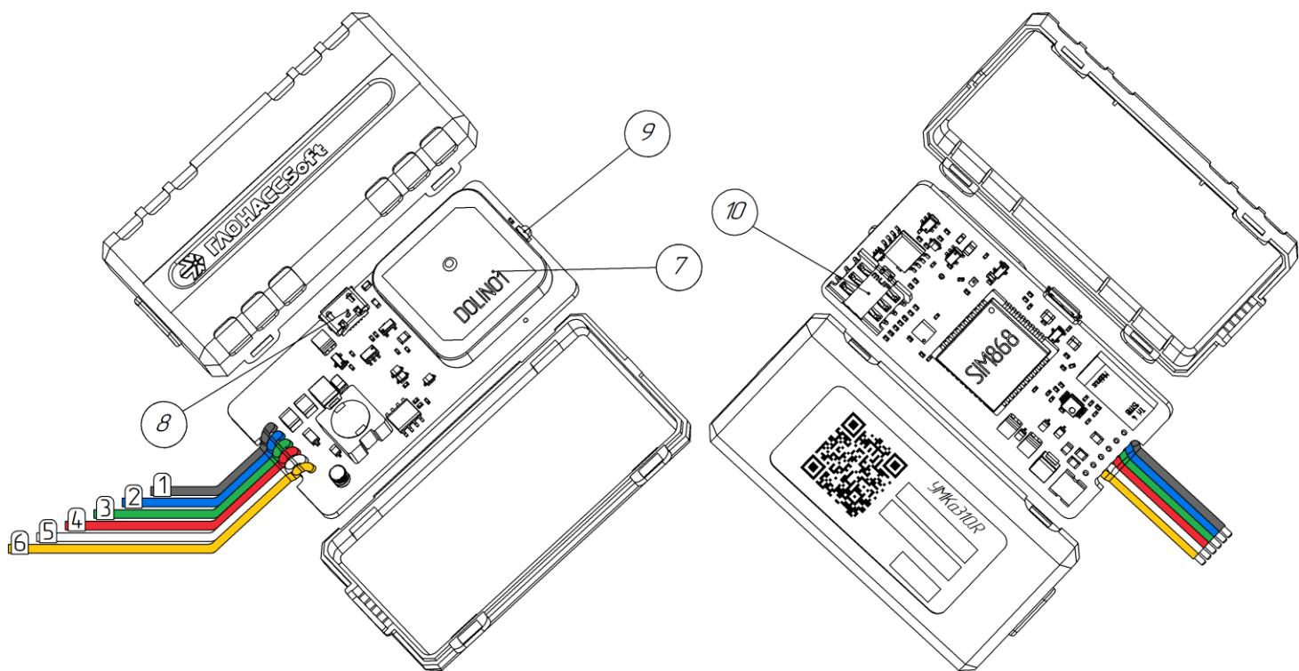
Рисунок 2.1 Основные элементы терминала УМКа310
