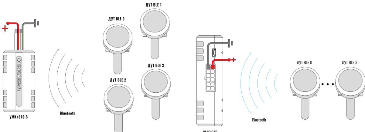
Рисунок 2.20 Подключение ДУТ по BLE (310 – слева; 312 - справа)
