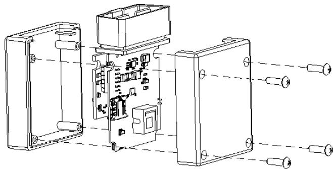
Рисунок 2.7 Вскрытие корпуса терминала (310 – слева; 312 – справа;
