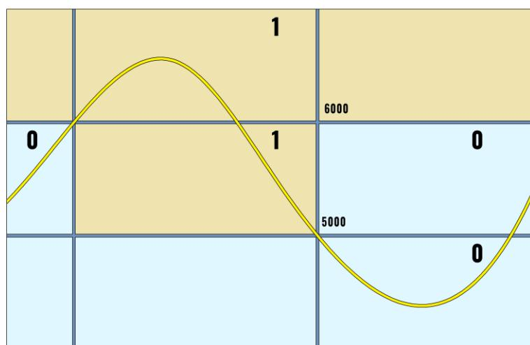
Рисунок 2.14 Преобразование аналогового сигнала в дискретный
