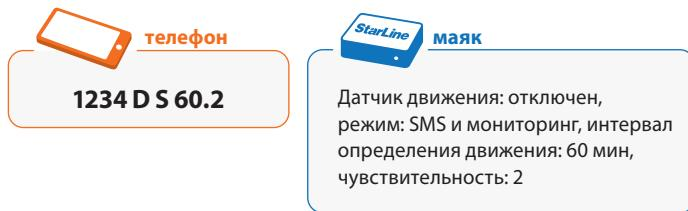
Для коррекции параметров режима уведомления можно воспользоваться сокращенным вариантом команды **D** (**Д**), указав только реакцию маяка на начало движения, время работы таймера или чувствительность (после точки).
