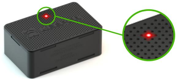
\* Если устройство мигнет **зеленым** светодиодом только один раз, значит оно ранее было включено и находится в данный момент в режиме сна.
