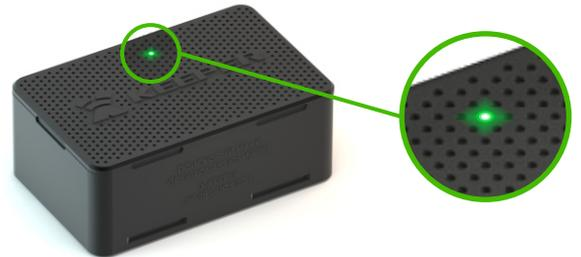
\* Если устройство начнет мигать **зеленым** светодиодом, значит Вы только что его включили и в данный момент устройство находится в режиме извещения.
