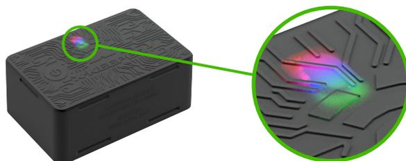
2. После успешного перезапуска включенного устройства, продолжится мигание одного **зелёного** светодиода.
