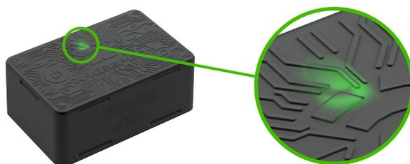
После успешного перезапуска выключенного устройства, светодиодная индикация прекратится.
